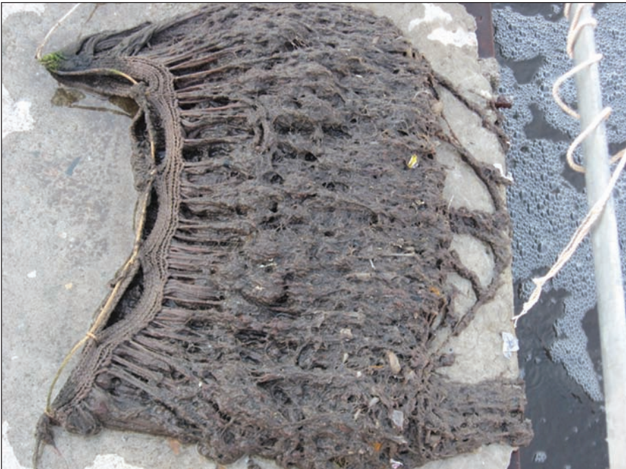
Рис. 2. Волокнистий полімерний носій, який встановлювали в аеротенку ЦОС-1 м. Запоріжжя
